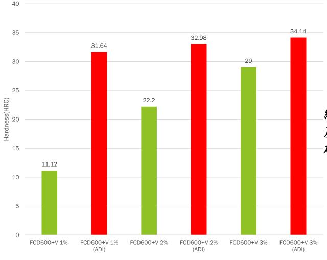
經由此數據得知FCD600+3%V的HRC硬 度測試結果較硬而FCD600+1%V較軟, 硬度比較為3%V>2%V>1%V
