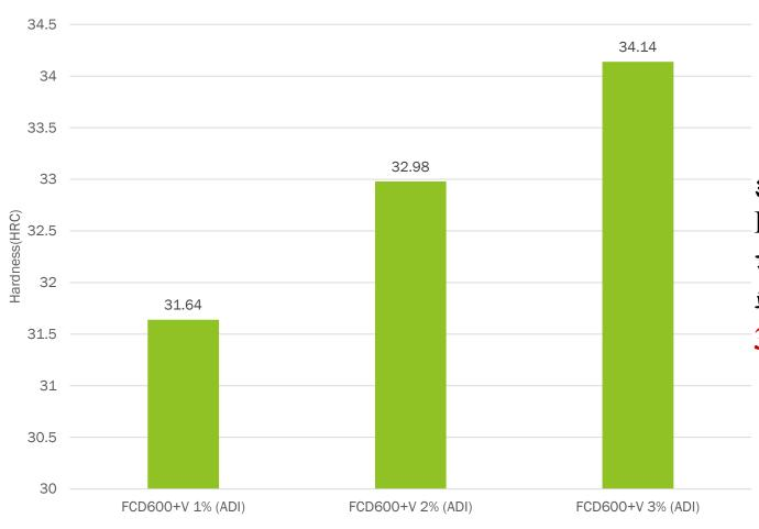
經由此數據得知 FCD600+3%V(ADI)的HRC硬度測 試結果較硬而FCD600+1%V(ADI) 較軟,硬度比較為 3%V>2%V>1%V
