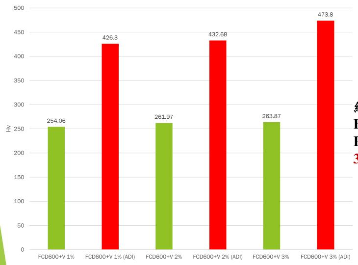
經由此數據得知FCD600+3%V的 HRC硬度測試結果較硬而 FCD600+1%V較軟,硬度比較為 3%V>2%V>1%V
