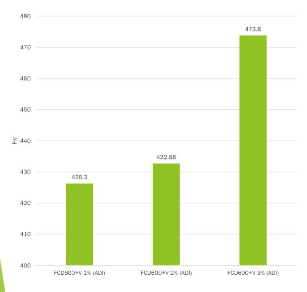
經由此數據得知FCD600+3%V的 HRC硬度測試結果較硬而 FCD600+1%V較軟,硬度比較為 3%V>2%V>1%V
