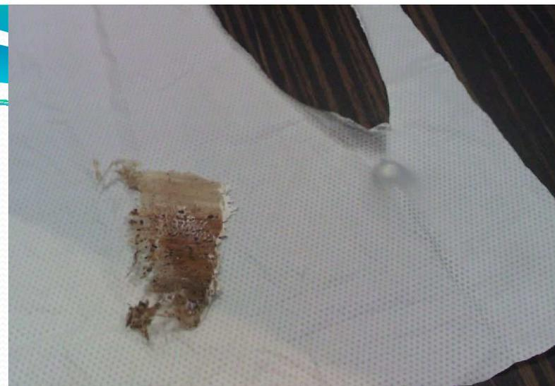
薄膜的破洞與前端白點，押出機螺桿剝下來的焦黑塑料
