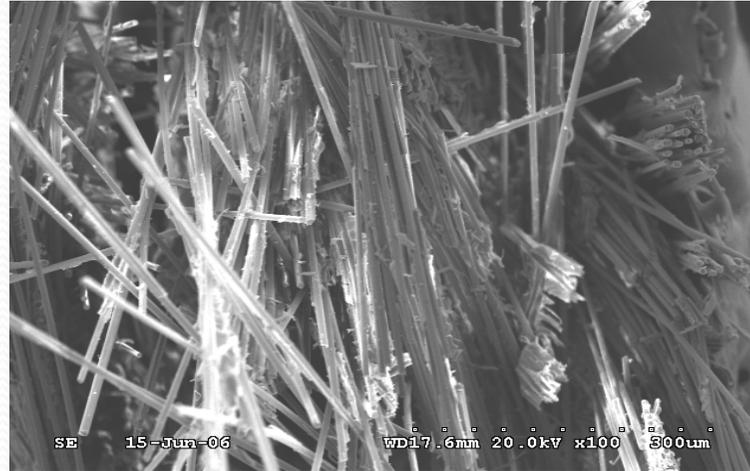
衝擊斷面電子顯微鏡分析
