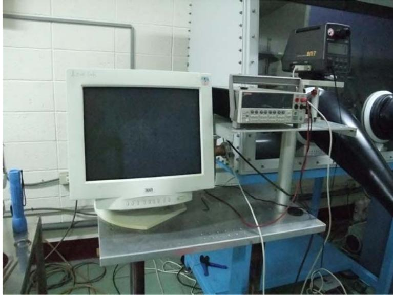
圖 3-17 同步量測 I-V-L 及電激發光光譜圖
