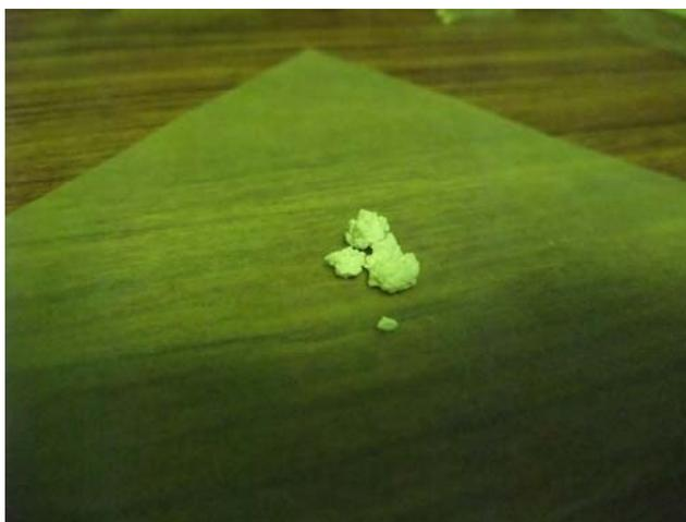
圖 3-8 實驗藥品：PS-b-PMMA ( 46100 : 21000 )，白色塊狀顆粒。
