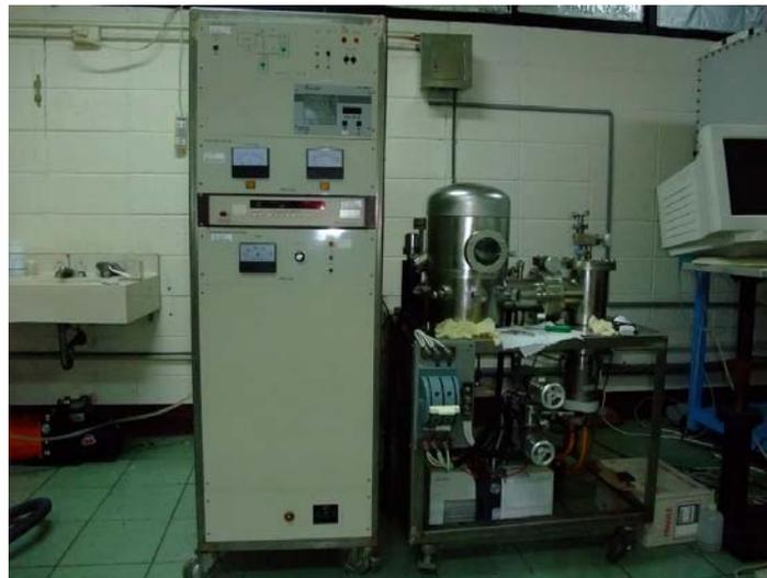
圖 3-2 真空熱蒸鍍機
