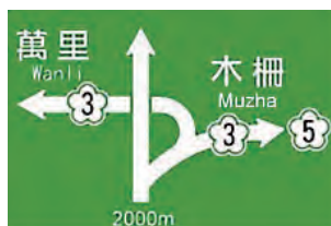
高(快)速公路出口預告
