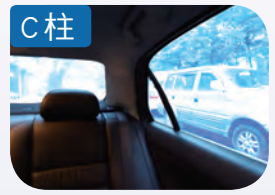
▲ A、B、C 柱所造成的視野死角。
