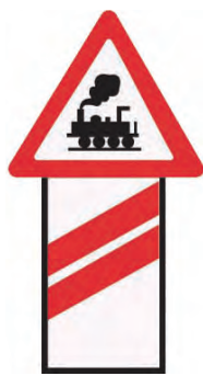
第二面無柵門 鐵路平交道
