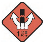
中間封閉 (前方 1 公里處置)
