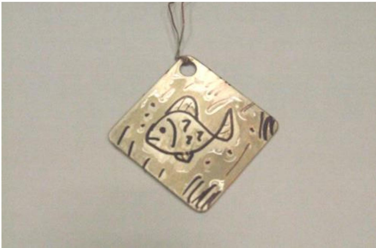
7. 用丙酮將圖像的墨蹟塗抹乾淨而得到最後的製成品，然後再一次秤重。
