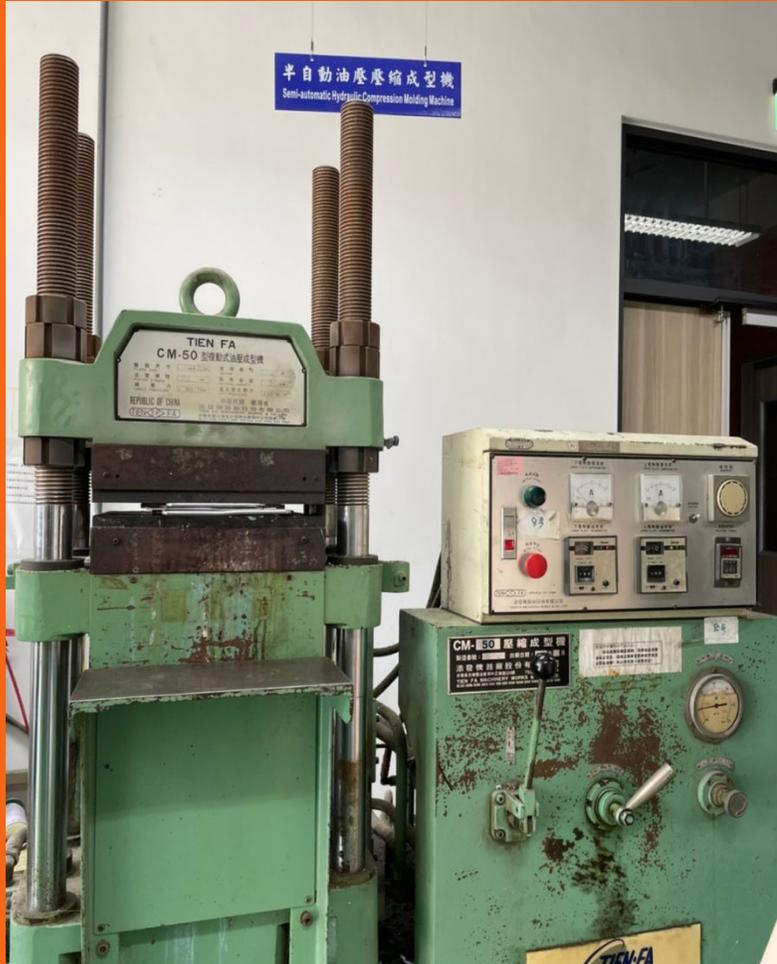
將混摻均勻材料經熱壓成測誦之標準誦片，藉由高溫高壓而形成。
