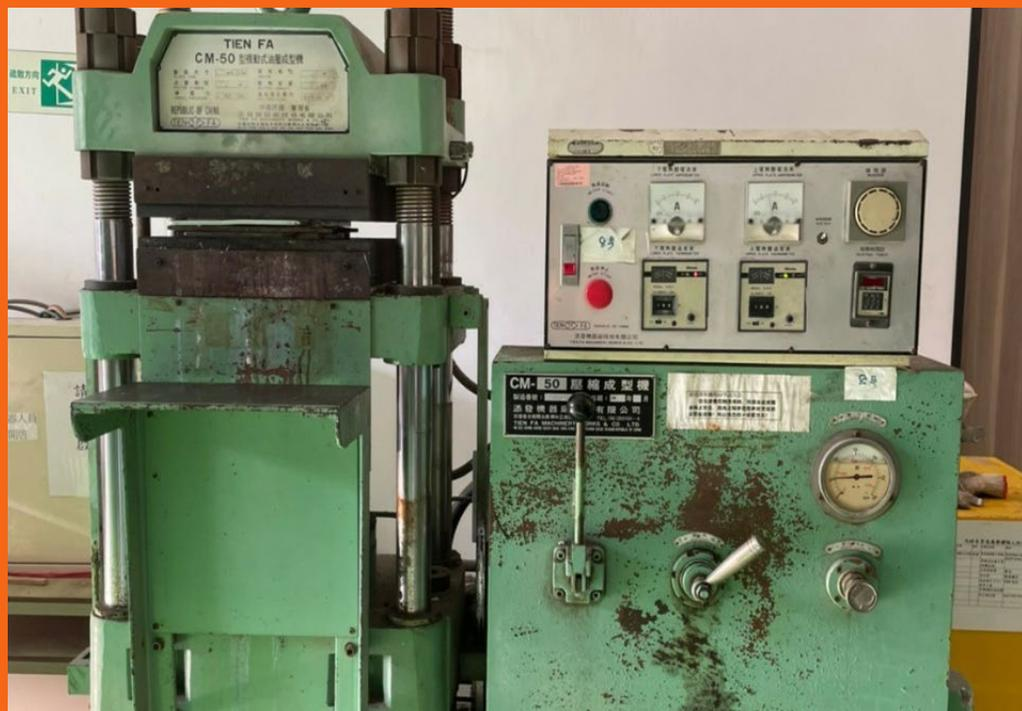
步驟3. 開啟半自動油壓壓縮成型機，並將兩塊鐵片放入壓縮機中，啟動壓縮機，在壓縮到鐵片的時候停止。
