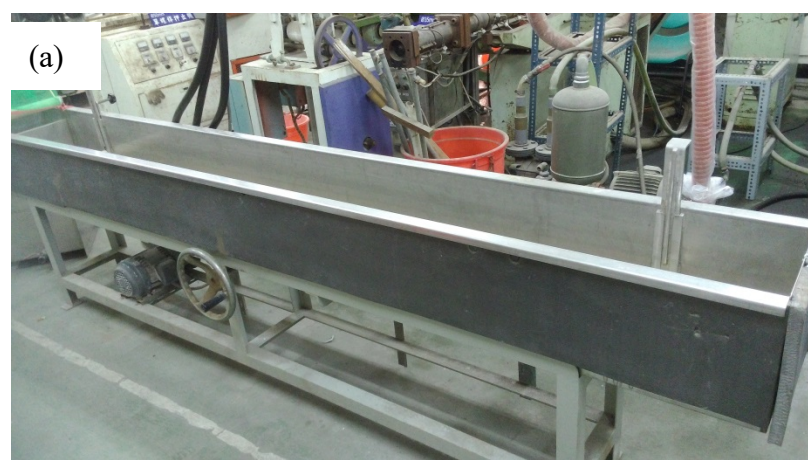
圖 4、冷卻系統與造粒機，(a)冷卻水槽，(b)切粒機。
