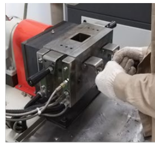
6. 將加熱後板置入，並鎖上固定加熱板螺絲。
