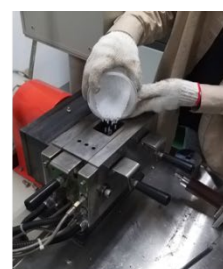
10. 等待溫度到達設定溫度時，按下啟動按鈕，並將材料倒入混練空間。
