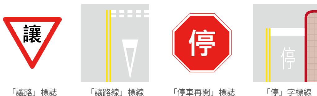
圖5-3-7 設置於支線道的交通標誌、標線
