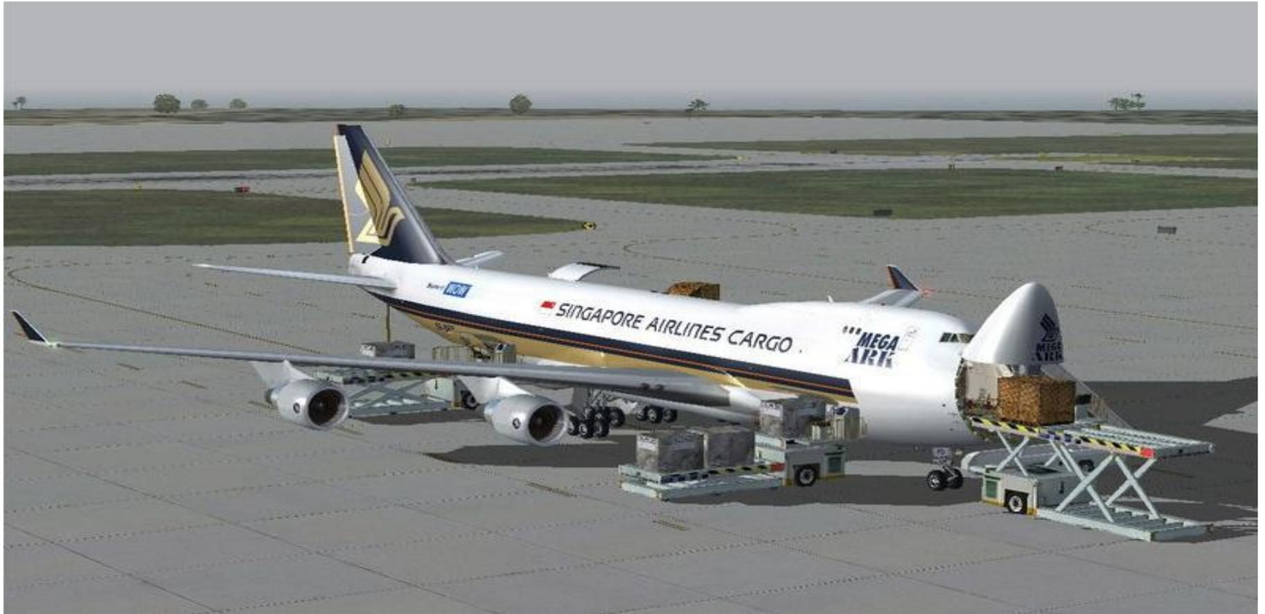
波音747，又稱為「空中巨無霸」，是世界上最易識別的飛機之一，亦是全世界首款廣體民航機，由美國波音公司（Boeing）製造。波音747是一款雙層四發動機飛機，能夠用來載客、貨或其它用途，它的上層甲板設計，使波音747貨機型號能夠在機首裝設一個貨艙門，波音747-400是747系列中最近投入服務的型號，其飛行速度與其它同類型飛機差不多，時速度0.85馬赫（567英哩或913公里），航程達7,260海哩（8,350英哩或13,450公里）
