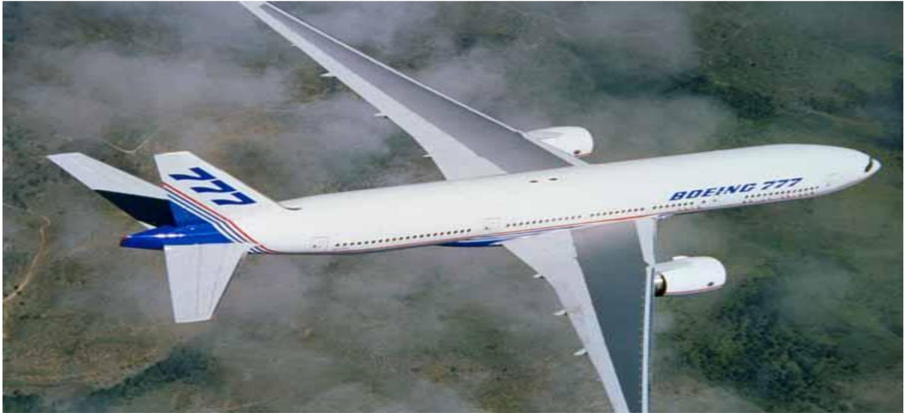
**波音777**是一款由美國波音公司製造的長程雙引擎廣體客機，是目前全球最大的雙引擎廣體客機，三級艙佈置的載客量由283人至368人，航程由5,235海里至9,450海里（9,695公里至17,500公里）。波音777採用圓形機身設計，起落架共有十二個機輪，所採用的發動機直徑也是所有客機之中最大的。波音投入了大量資源以開發777，為波音史上第二次的豪賭，假如失敗，波音可能難逃破產命運，但結果證明波音777是一款成功的飛機。波音777的直接競爭對手是A330-300、A340和仍開發中的A350XWB。直至2008年8月，共有56家航空公司訂購了1,092架波音777。
